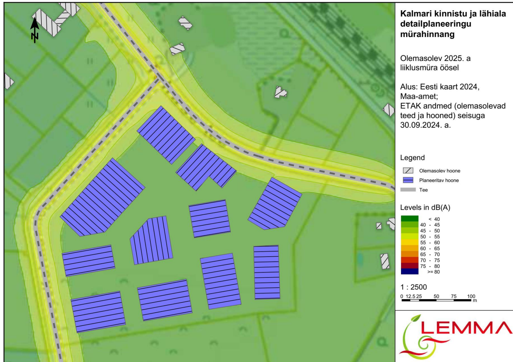
Joonis 6. Olemasolev liiklusrüüra öösel 2 m kõrgusel maapinnast.
